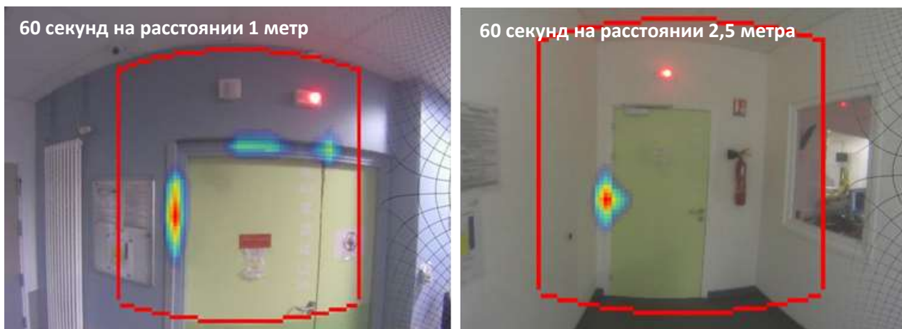
Рисунок. Утечка рентгеновского излучения (50-100 кэВ) вокруг дверных петель в больнице
